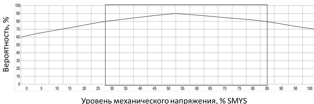
Рисунок 3 – График достоверности определения опасных участков методом магнитной томографии (МТМ)
