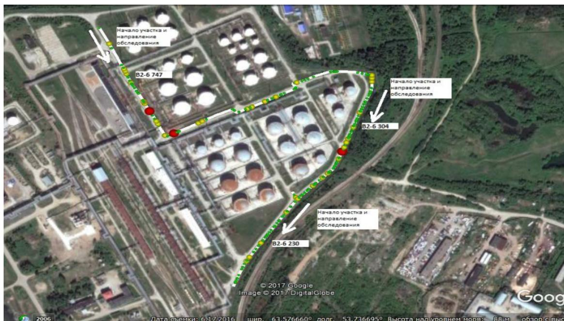
**Рисунок 4** Результаты сканирования противопожарного трубопровода В2-6
